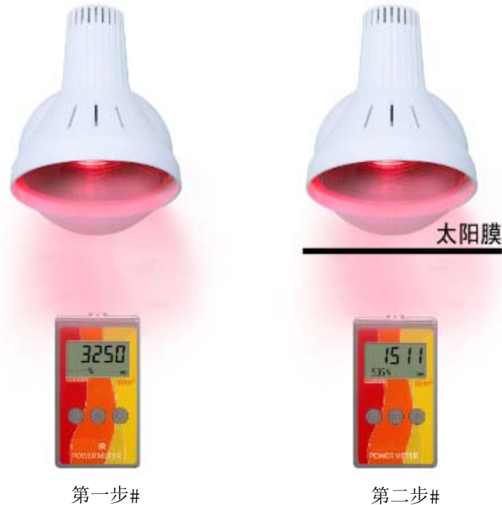
图 1 对太阳膜隔热性能的测量
