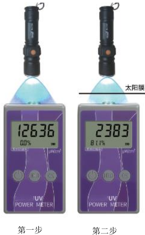
图 1 对太阳膜隔热性能的测量
