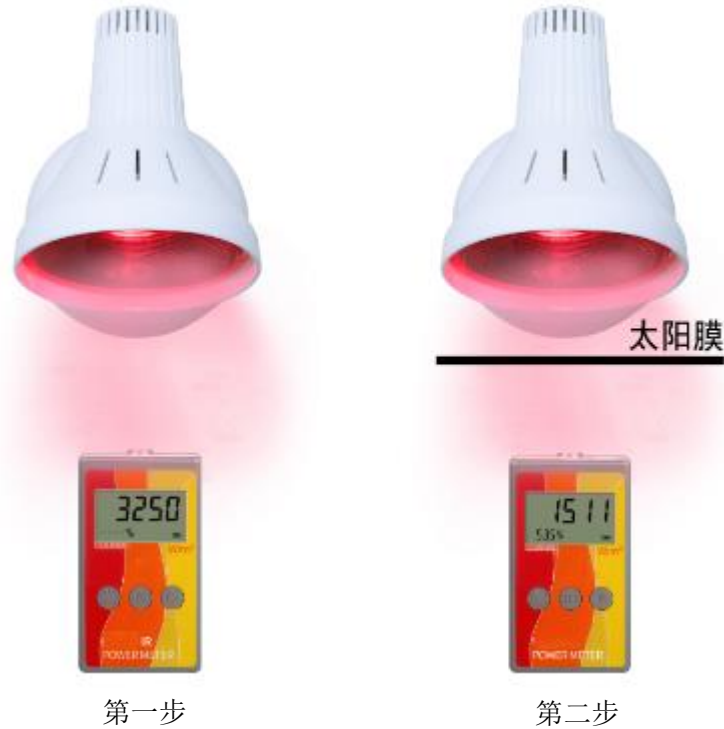
图 1 对太阳膜隔热性能的测量
