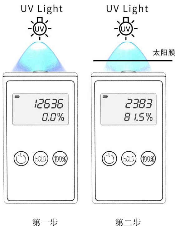
图 1 对太阳膜隔紫外性能的测量
