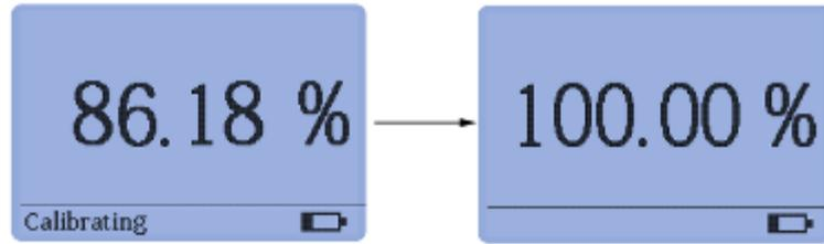
手动校准到 100.00%时，如果界面左下角出现“Calibration failed”提示，说明校准失败，手动校准失败可能有以下两个原因引起：
