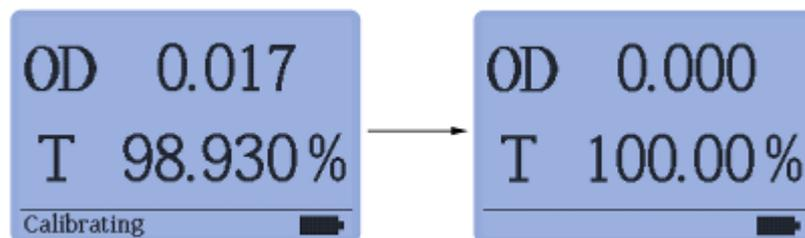
手动校准到 100%时，如果界面左下角出现“Calibration failed”提示,说明校准失败,
