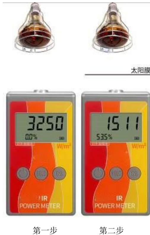
图 1 对太阳膜隔热性能的测量
