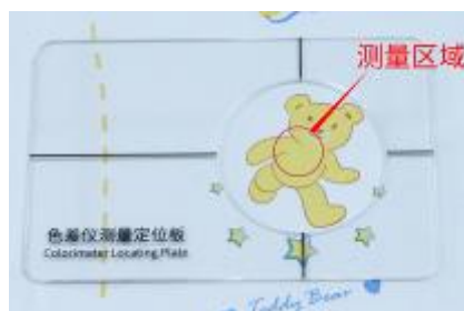
定位孔中心对准测量区域
