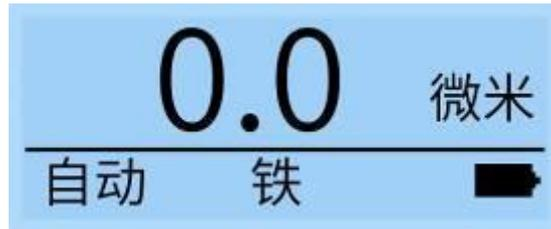
3.5 调零完成后，将标有标准数值的测试片放在调零板或基体上测量，如果数值稳定且与标准片上标定的数值一致（误差在±5微米内），说明仪器可以正常使用了。
